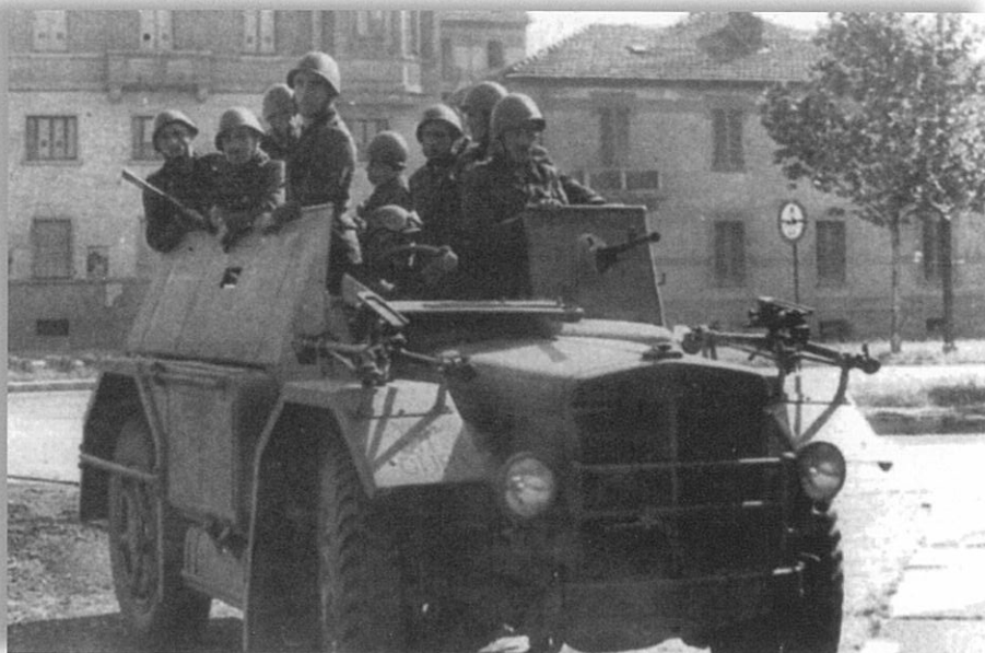
Altra immagine di autoprotetta su telaio AS43. Si nota che poteva trasportare 8 uomini oltre al conducente, che guida con il parabrezza abbassato e munito di occhialini da motociclista.
